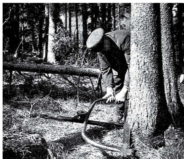
Obr. 3.22: Jerker - pomocné řezací zařízení pro obloukovou pilu (1918).
