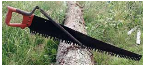
Obr. 3.21: Sägkamraten, spirálová pružina usnadňující pohyb pily „od sebe“.
