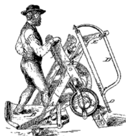
Obr. 3.11: Alderova pila z roku 1862, alternativně vybavená kotoučovou nebo kmitací pilou. (Podle patentového spisu 35,805, Jul. 08. 1862, Directory of American Tool and Machinery Patents).
