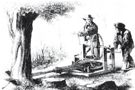
Obr. 3.01: Mechanická Hamiltonova Drag saw poháněná klikou (červen 1835).
