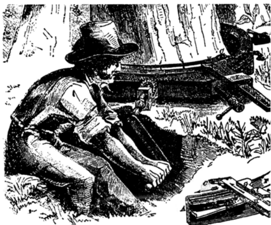
Obr. 3.03: Kácací stroj George C. Ehrensa z roku 1856 (ilustrace Rebe Goldberg, patentová dokumentace žádný celkový obrázek neobsahuje).
